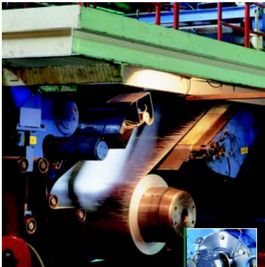
Qualitätsstahl aus Schweden: Bei der Herstellung und Alu-Zink-Laminierung von Stahlblechen sind 15 Digital-Tachos HOG 9 und zwei hochauflösende HOG 100 entscheidend an der Qualität des Produktionsprozesses beteiligt.
