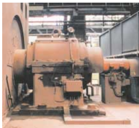
Bild 5: Jahrzehnte im Betrieb und immer noch top in Form; ein Doppel-Tacho mit zwei hintereinander angeordneten Ankerpaketen hinter dem Lagerbock eines 8,7 MW-Antriebs (TDP 60 + TDP 60).
