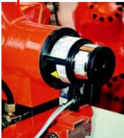
■ Der Tacho bzw. Doppel-Tacho hat einen B-seitigen Flansch und ein zweites Wellenende, an das über einen Zwischenflansch („Laterne“) und Kuppelung der eigengelagerte Digital-Tacho (oder Fremdgeber) angebaut wird:
