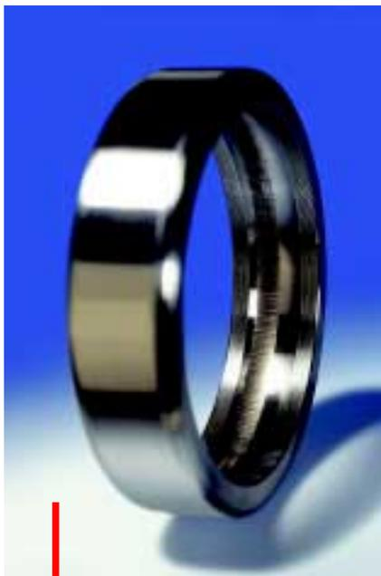
Bild 18: Von Wellenströmen geschädigte Kugellager sind durch eine riffelförmige Lauffläche gekennzeichnet.
