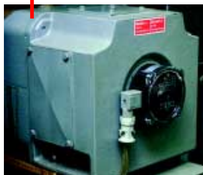
Bild 12: Hohlwellen-Tacho (GTB 9 in IP 68) an einer Präzisions-CNC-Maschine.
