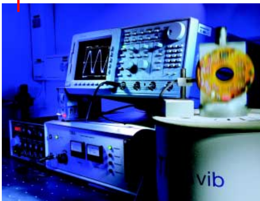
Bild 19: Schwingungsprüfung, insbesondere hinsichtlich Resonanzfrequenzen, der Elektronik-Platine eines HeavyDuty®-Digital-Tachos für die Analog-Digital-Kombination TDP 0,2 + OG 9 im Frequenzbereich 2 Hz bis 4 kHz auf einem luftgelagerten Meßplatz.
