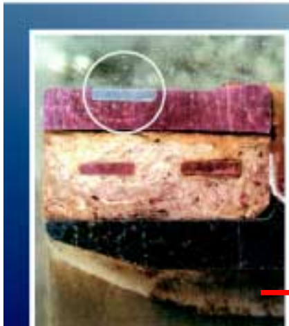
Bild 7: Hohlwellen-Anker (GTB 9) mit eingebetteter Silberspur.
